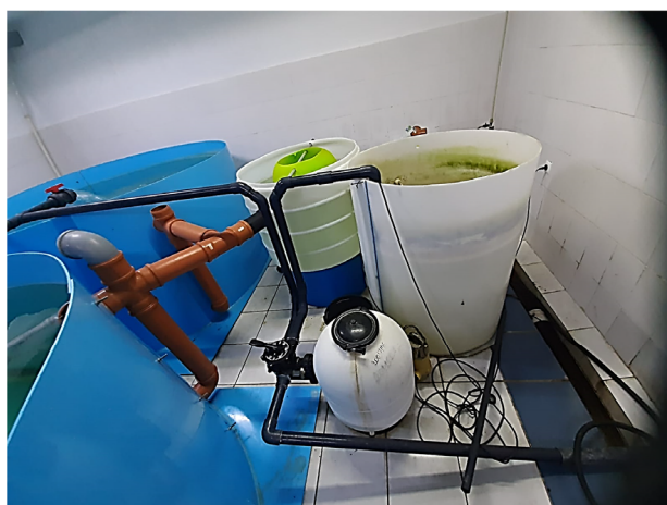
Рисунок 5 – Установка замкнутого водоснабжения НИЦ «Рыбное хозяйство» для выращивания судака
