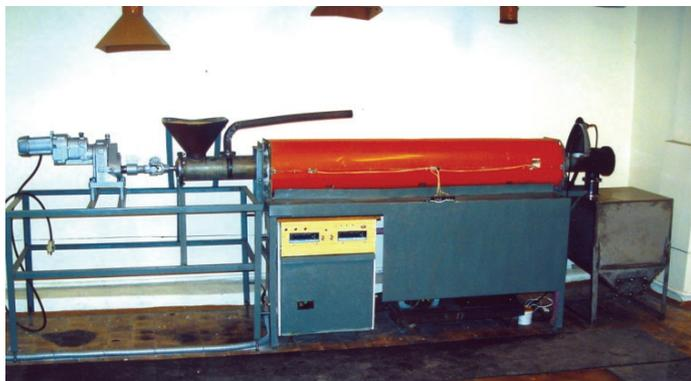
Рисунок 1 - Пилотная установка для карбонизации
