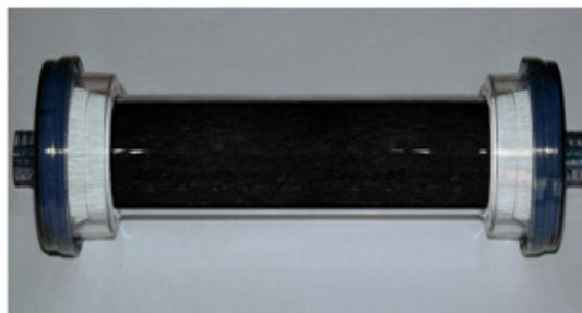
Рисунок 3. Гемосорбент в картридже
