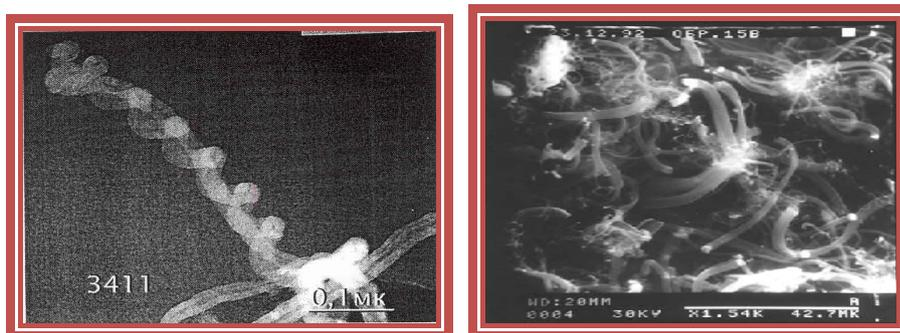
Рисунок 1. Электронные микрофотография углеродных нанотрубок полученных при изучении образования каталитического углерода на хромитовом шламе
