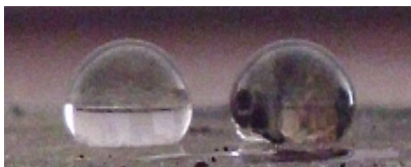
3-сурет – Алынған гидрофобты бетке отырғызылған су тамшыларының көрінісі
