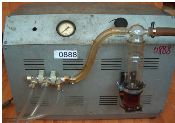
1-сурет – Күріш гибридизациясына арналған 3-каналды пневмокастратормен оранжереялық жағдайда кастрация жүргізу
